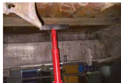
Выправка центрального ребра жесткости люка
