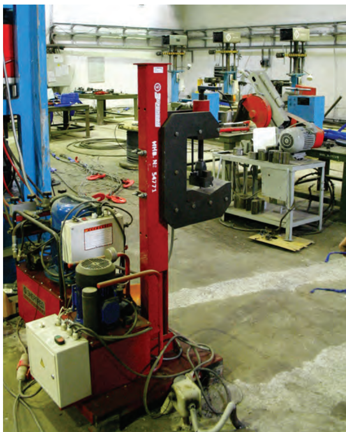
Установка клеймения гидравлическая УКГ-8П «Энерпром» в цехе по производству стальных канатных стропов ОАО «Белорецкий металлургический комбинат»
