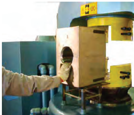
Монтаж матриц в пресс серии «Advanced»
