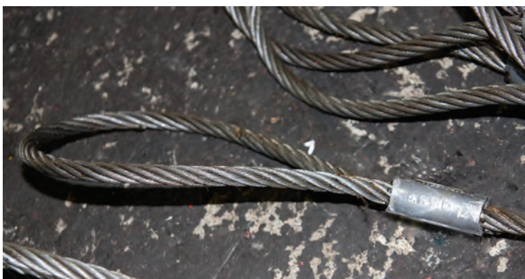
Строп с маркировкой на обжимной втулке
