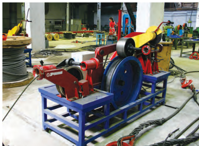
Установка УРКС-65 «Энерпром» в цехе по производству стальных канатных стропов ОАО «Белорецкий металлургический комбинат»
