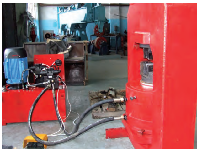
Пресс ППК-С600-ПРОФ «Энерпром» на производстве в ЗАО «Сахалинремфлот»
