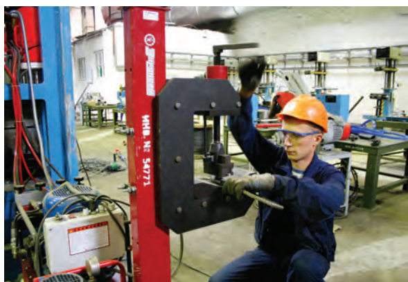
Маркировка стропы на обжимной втулке на оборудовании УКГ-8П «Энерпром» в цехе по производству стальных канатных стропов ОАО «Белорецкий металлургический комбинат»
