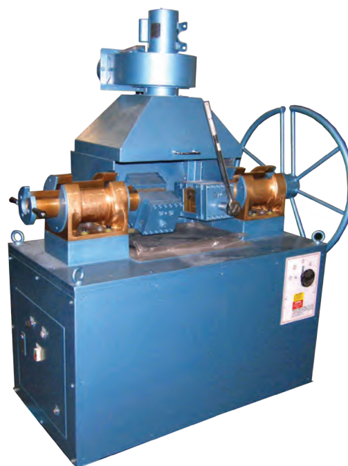
Станок для прокаливания и закручивания конца каната СП3-36
