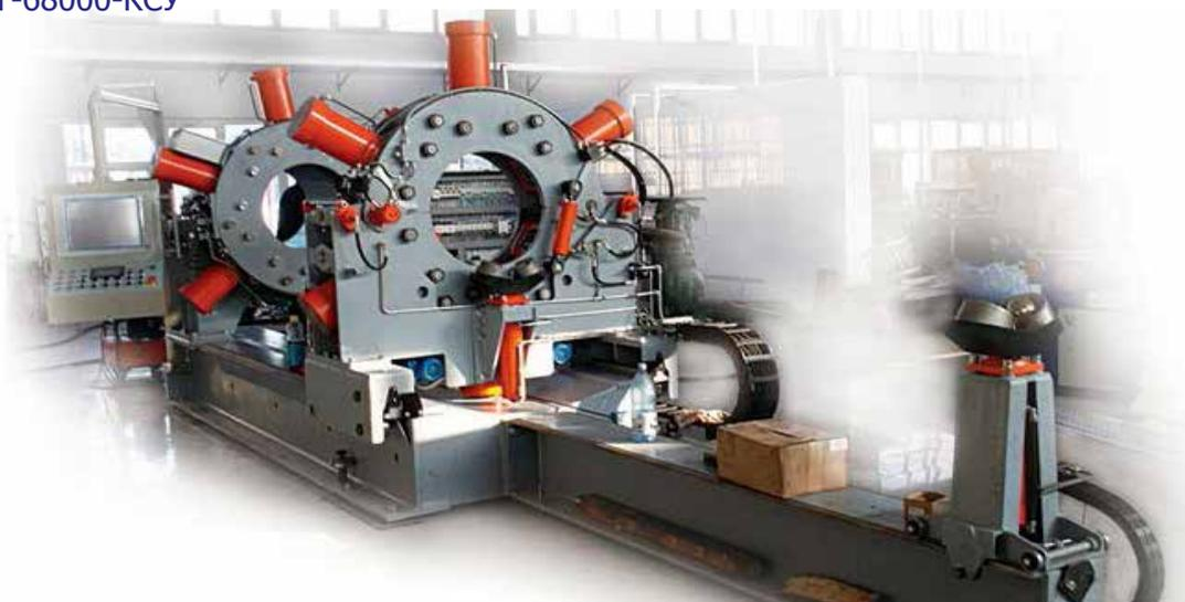
■ Оборудование предназначено для контроля крутящего момента затяжки резьбовых соединений буровых труб.
