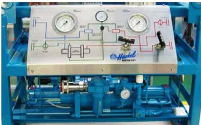
Одноступенчатые компрессоры прямого действия модели **AG** являются экономичным вариантом при создании давления для испытаний небольших компонентов с малыми рабочими объемами, когда величина КПД не является важным параметром. Контроль максимального давления осуществляется регулятором, приводимым давлением сжатого воздуха.
