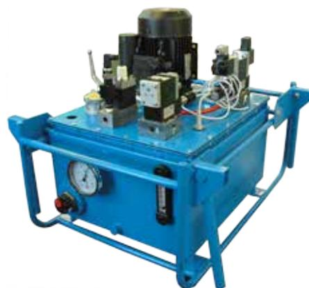
Агрегат гидравлический АГ25-42/480-УБ предназначен для перемещения буровой установки по направляющим с помощью 2-х гидроцилиндров, выравнивания верхнего лебедочного блока, обеспечения соосности ротора и буровой колонны с помощью 4-х групп домкратов
