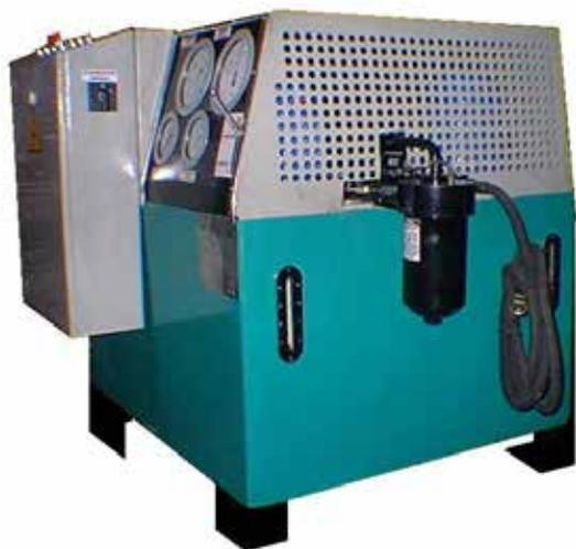
■ Гидравлический стенд для испытаний поршней, вкладышей и процесса скольжения между ними, применительно к глубинным насосам типа RLA.
