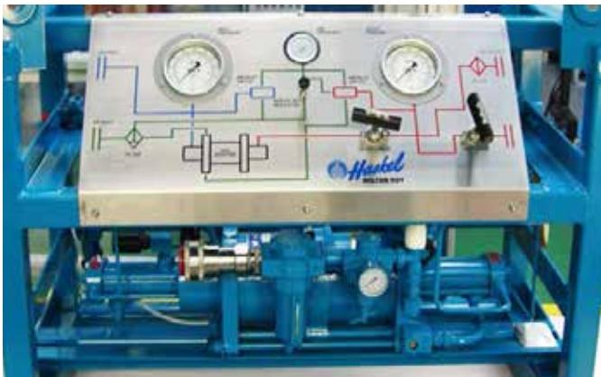
Одноступенчатые компрессоры прямого действия модели **AG** являются экономичным вариантом при создании давления для испытаний небольших компонентов с малыми рабочими объёмами, когда величина КПД не является важным параметром. Контроль максимального давления осуществляется регулятором, приводимым давлением ската газа.
