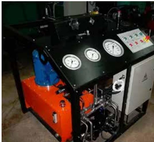
■ Гидравлический стенд используется для испытаний давлением нефтедобывающего оборудования: кранов, превенторов, фонтанной арматуры, сосудов высокого давления и т.п..
