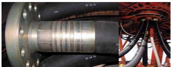
изготовление буровых рукавов нестандартных размеров до 25 метров включительно.
