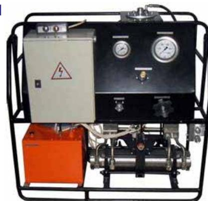
■ Гидравлический стенд СИ-С-А-А-110/1-1/10-К-СУЭ предназначен для тестирования давления и испытаний устьевого оборудования нефтяных и газовых скважин.
