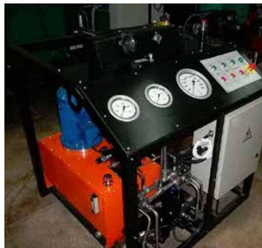
■ Гидравлический стенд используется для испытаний давлением нефтедобывающего оборудования: кранов, превенторов, фонтанной арматуры, сосудов высокого давления и т.п..
