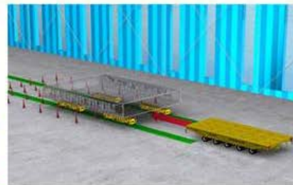
Подвести судовой транспортер под собранную секцию судна
