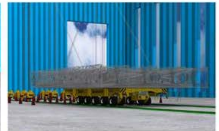
Переместить секцию судна судовым транспортером в покрасочный цех
