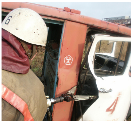
СПИИ с установленной насадкой РБС-1 и удлинительными рукоятками
